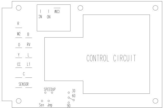
FIGURE 11 HEAT PUMP CONTROL BOARD
